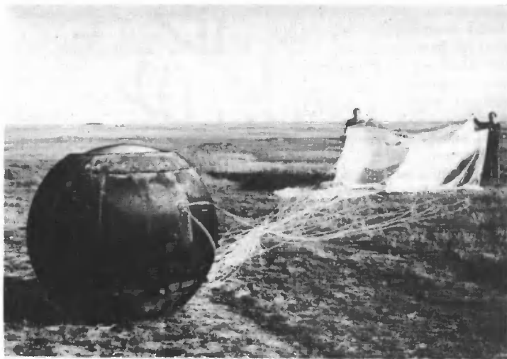
Спускаемый контейнер «Вертикали-8» с научной аппаратурой после приземления.
